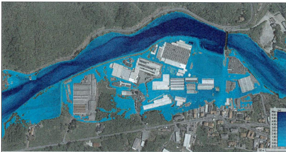
Figura 42 – Carta dei battenti idraulici massimi al colmo di piena per Tr 200 anni – loc. Torame.
