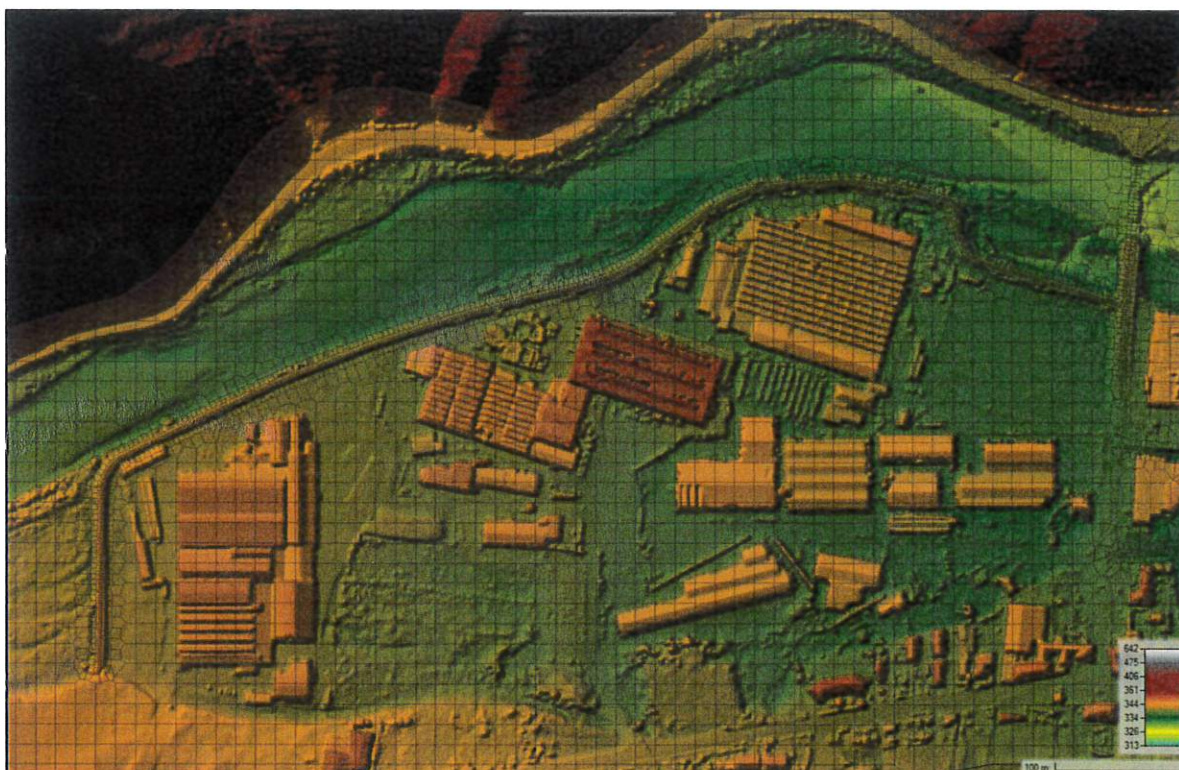
Figura 21 – Dominio di calcolo e rappresentazione della maglia su base DTM: dettaglio di infittimento delle celle di calcolo in alcune aree di maggiore interesse per lo studio del deflusso di piena, quali in particolare la linea arginale a difesa degli stabilimenti limitrofi e il rilevato stradale dal quale emerge il ponte di Bornate.
